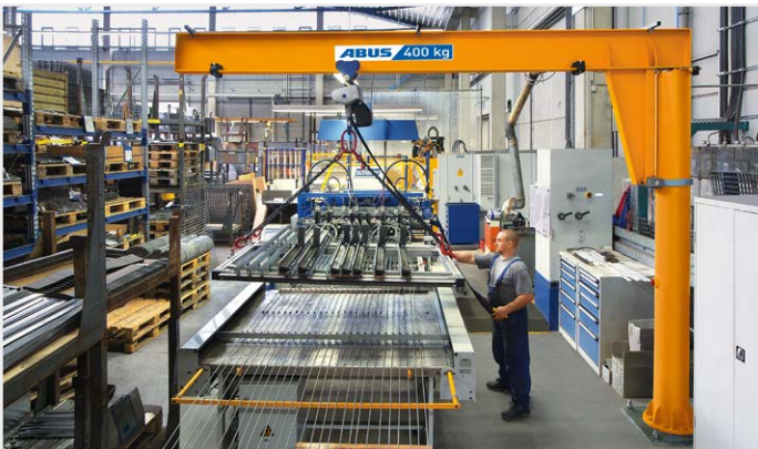
Roterbar 360° ABUS pelarsvängkranar, upp till 6,3 t (upp till 4 t. med kättingtelfer)
