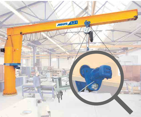
Elektriskt åkverk (bild 1)
