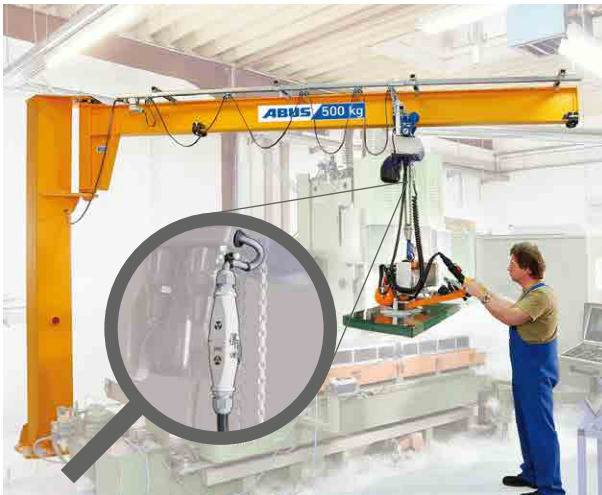
Svängkran med vakuumutrustning med extra anslutningskontakt (bild 13)
