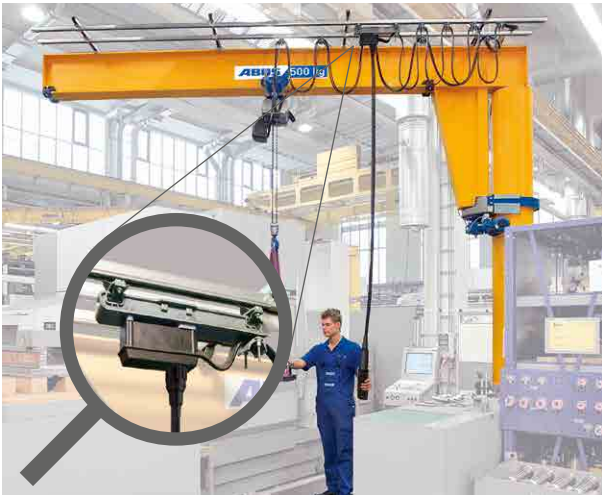
Separat åkbart manöverhandtag (bild 11)
