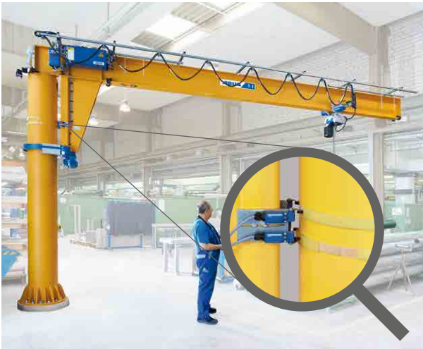
Gränslägesbrytare för svängmaskineri (bild 6)
