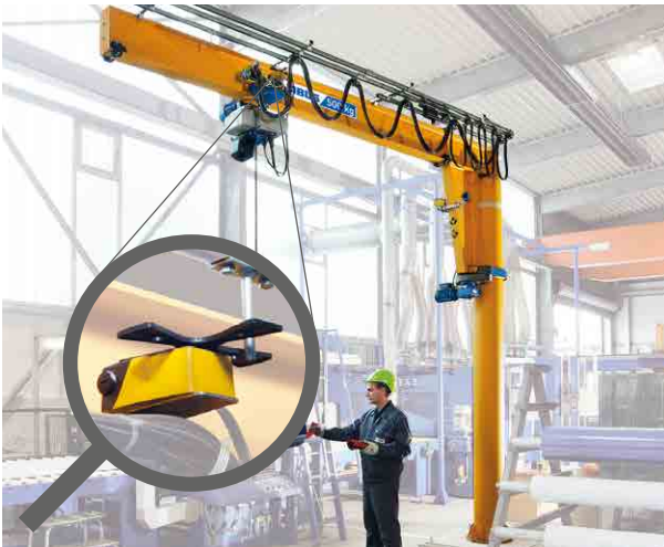
Gränsbrytare för elektriskt telferåkverk (bild 8)
